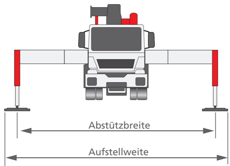
Die angegebenen **Abstützbreiten** werden jeweils von der Mitte des Stützfußes gemessen. Unterlegplatten und eventuell erforderliche Kanthölzer müssen bei der Ermittlung der benötigten **Aufstellweite** entsprechend berücksichtigt werden.
