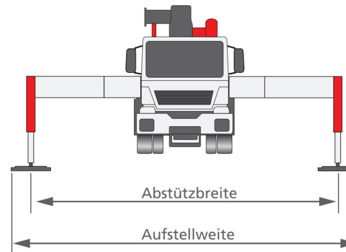
Die angegebenen **Abstützbreiten** werden jeweils von der Mitte des Stützfußes gemessen. Unterlegplatten und eventuell erforderliche Kanthölzer müssen bei der Ermittlung der benötigten **Aufstellweite** entsprechend berücksichtigt werden.
