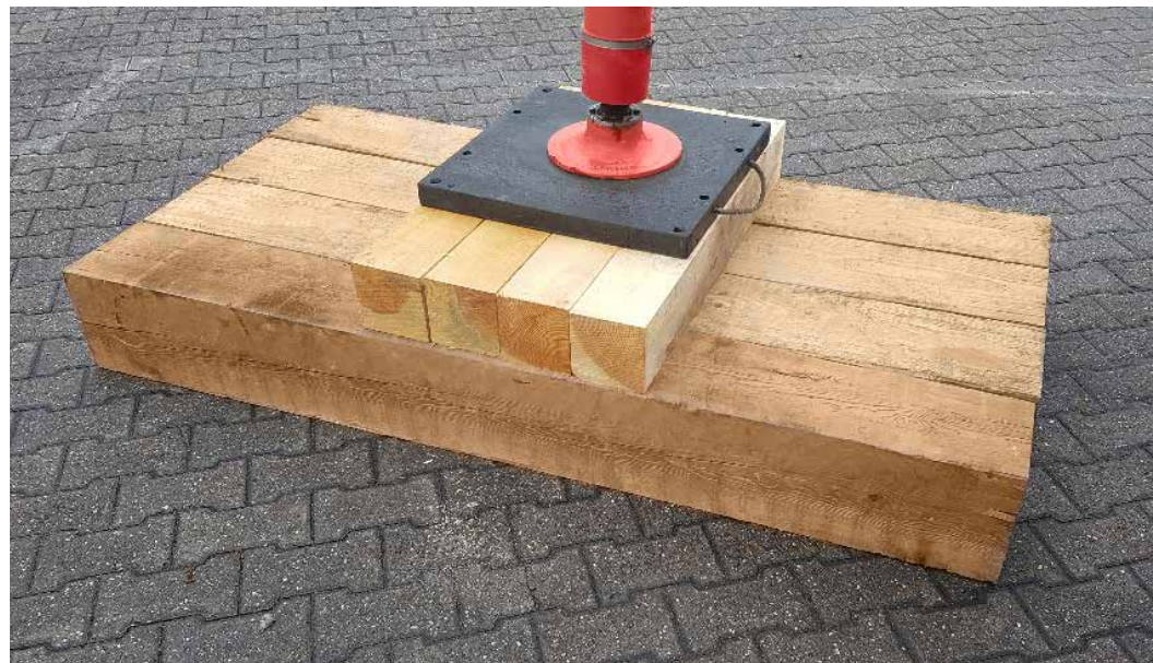
Lastverteilung durch Holz tragbar
