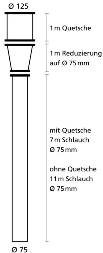
**Der handgeführte Endschlauch darf während des Betoniervorgangs eine max. Länge von 4 Metern zwischen Fallbogen und Schalung nicht überschreiten. Ansonsten muss der Endschlauch getauscht werden.**
